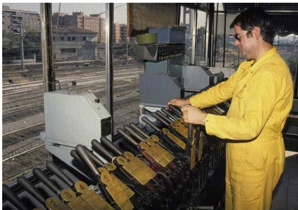
Figura 30: cabine com alavancas intertravadas representando rotas na região da estação.
