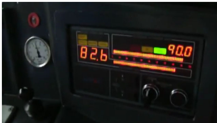
Figura 41: painel de trem da CPTM operando em ATC. A velocidade atual é de 82,6 km/h e a máxima é de 90 km/h. A cada instante, o maquinista pode verificar a velocidade máxima permitida. Fonte: Márcio Henrique (2009).
