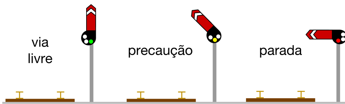
Figura 28: sinaleiros mecânicos com indicação luminosa. Fonte: PITA (2008, adaptado).
