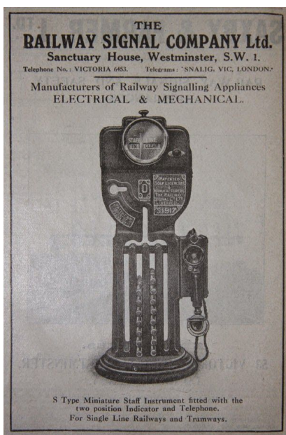
Figuras 31 e 32: aparelho de staff inglês e troca de bastões em uma estação australiana, respectivamente. Fontes: Grace's Guide to British Industrial History e Johnny's Pages, respectivamente.
